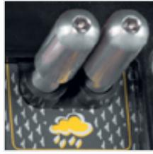
Dank des Regensensors kehrt der Roboter selbständig in seine Ladestation zurück und wartet auf Wetterbesserung. Er holt die versäumte Arbeitszeit bei schönem Wetter nach.
