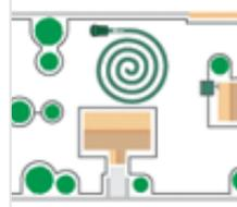
Die meisten Modelle sind mit einem Widerstandsensoren am Messermotor ausgestattet: Dadurch erkennen die Roboter, wie hoch und wie dicht das Gras ist. Besonders effizient mähen sie an diesen Stellen in Form der intelligenten Spirale.
